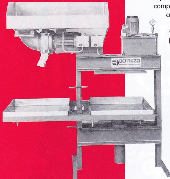
Presse hydraulique à paquet de type compacte, complète de broyeur et apte à travailler kg/h 300 environ de pommes et d'autres fruits.
