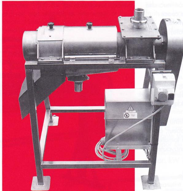
Pressa continua monovite con tamiz horado ( $\varnothing$  3 mm), tampon de descargo por contrapeso, para exprimir uva, corteza de tomate y de agrios o fruta tritada.
